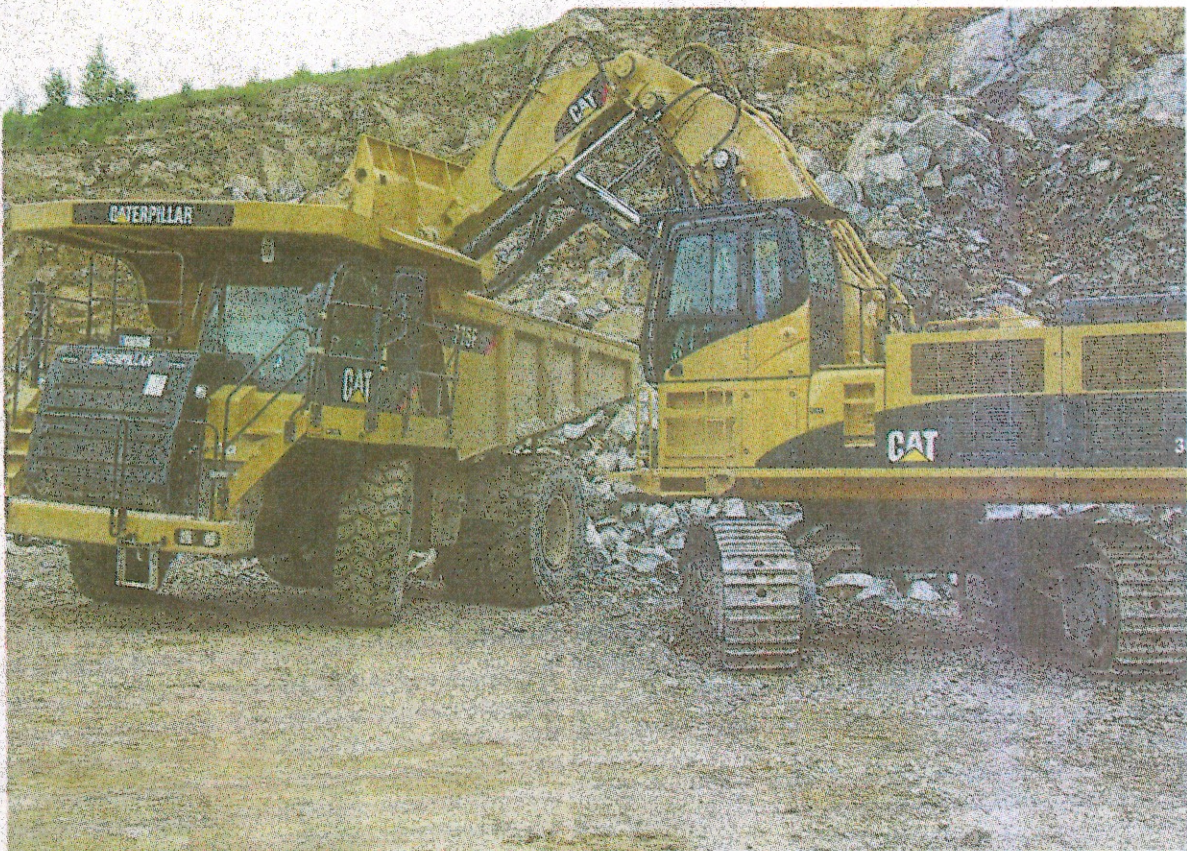
Mit sechs Schaufeln ist der 70-Tonnen-Muldenkipper mit Gestein voll beladen.
