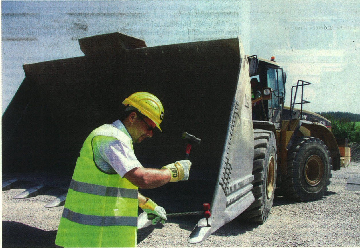
Die Zahnspitzen an der Radladerschaufel und am Baggerlöffel müssen in regelmäßigen Abständen ausgewechselt und ersetzt werden. Dies führt hier Jens Heerdegen vor, der bei Zeppelin verantwortliche Produktmanager für Zahnsysteme und Verschleißschutz. Fotos: Zeppelin
