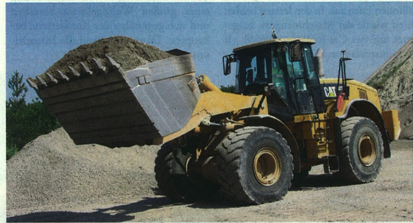
Die Radladerschaufel ist einem permanenten Verschleiß ausgesetzt, wenn sie in das Haufwerk eindringt.
