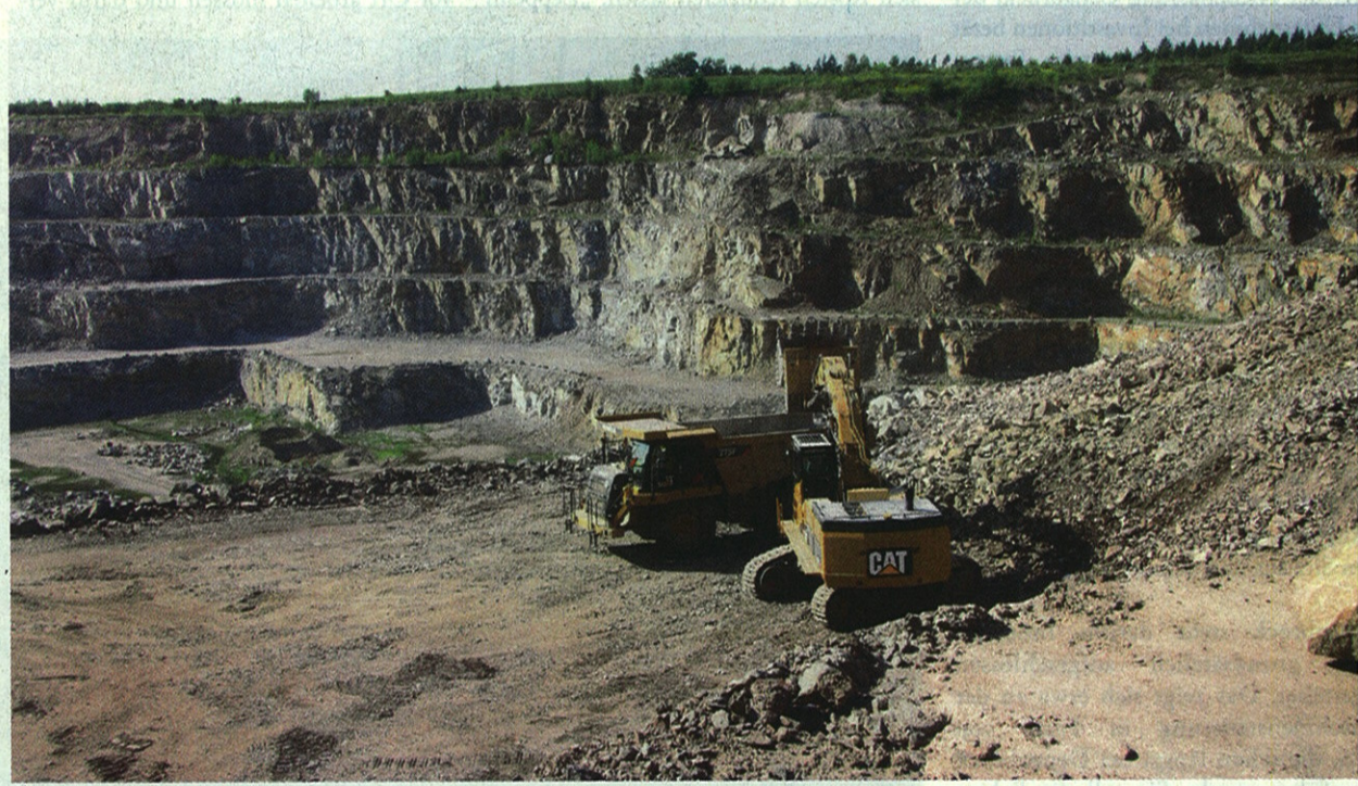
Der Steinbruch samt Schotterwerk hat es mit hochabrasivem Material zu tun, wenn die Rohstoffe gewonnen werden, um daraus jährlich annähernd eine Million Tonnen, vorrangig Gleisschotter, Edelsplitt für den Straßen- und Betonbau, Wasserbausteine sowie Gemische, herstellen zu können.
