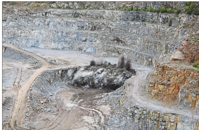
Das Gestein wird durch die Detonation gelöst ...
